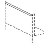
**Abdeckprofil oben aus Aluminium – für Aufsatzmodule**
