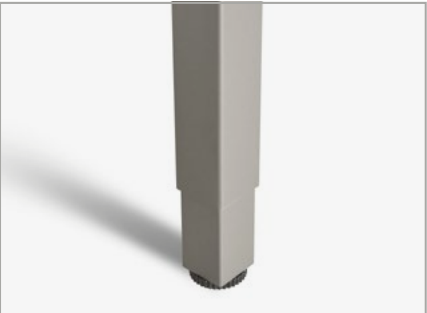
Quadro Quadratrohr Rohr in Rohr · Höhenverstellung manuell in 20 mm-Schritten (650–850 mm)
